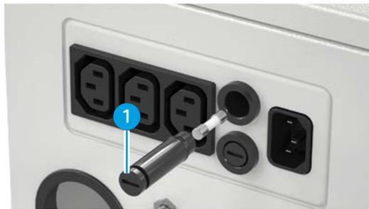
交货时，在仪器台车中安装了 2 个保险丝 T 10 A H/250 V，用于将仪器与 220 V-240 V 的电压相连。
