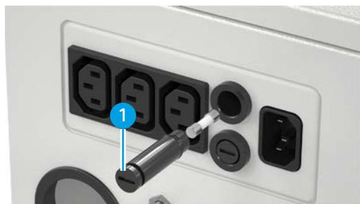
Kolica za uređaje se isporučuju s 2 osigurača T 10 A H / 250 V za priključivanje uređaja koji rade na naponu raspona 220 V - 240 V.
