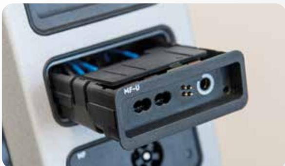
Buchsen können einfach vor Ort ausgetauscht werden. Dazu muss weder das Gehäuse geöffnet noch eine STK erfolgen.
