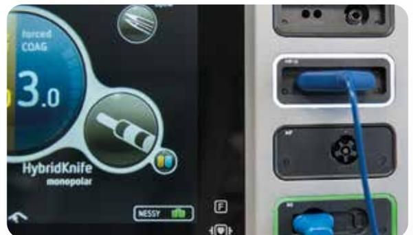
En la pantalla y en el marco iluminado del conector se indican la posición de conexión activa y su instrumento de trabajo.
