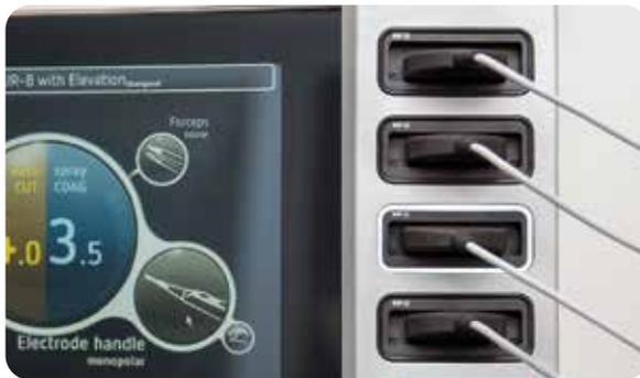
4 instrumentos monopolares, 4 instrumentos bipolares, 4 instrumentos plug-and-play (p. ej. BiClamp®) o cualquier combinación de estos.
